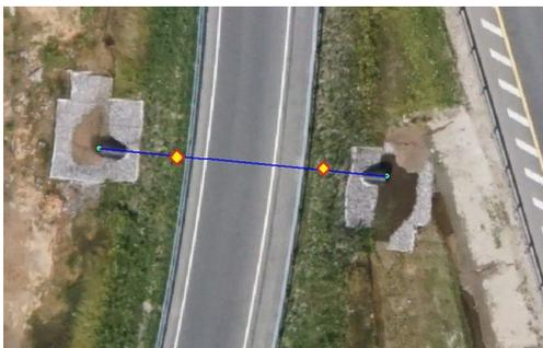
**5 — раструб/портал.** Включает в себя элементы раструба/портала водопропускной трубы. Если толщина стенок раструба одинакова, допускается координирование только внутренних точек открылков:
