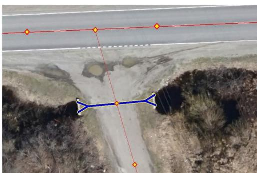
**2 — ось трубы.** Точки, которые нужны для создания фигуры трубы в IndorRoad, расчёта её длины и уклона. Снимаются две точки: в центре раструба/портала/отверстия тела трубы с каждой стороны. Примеры:
